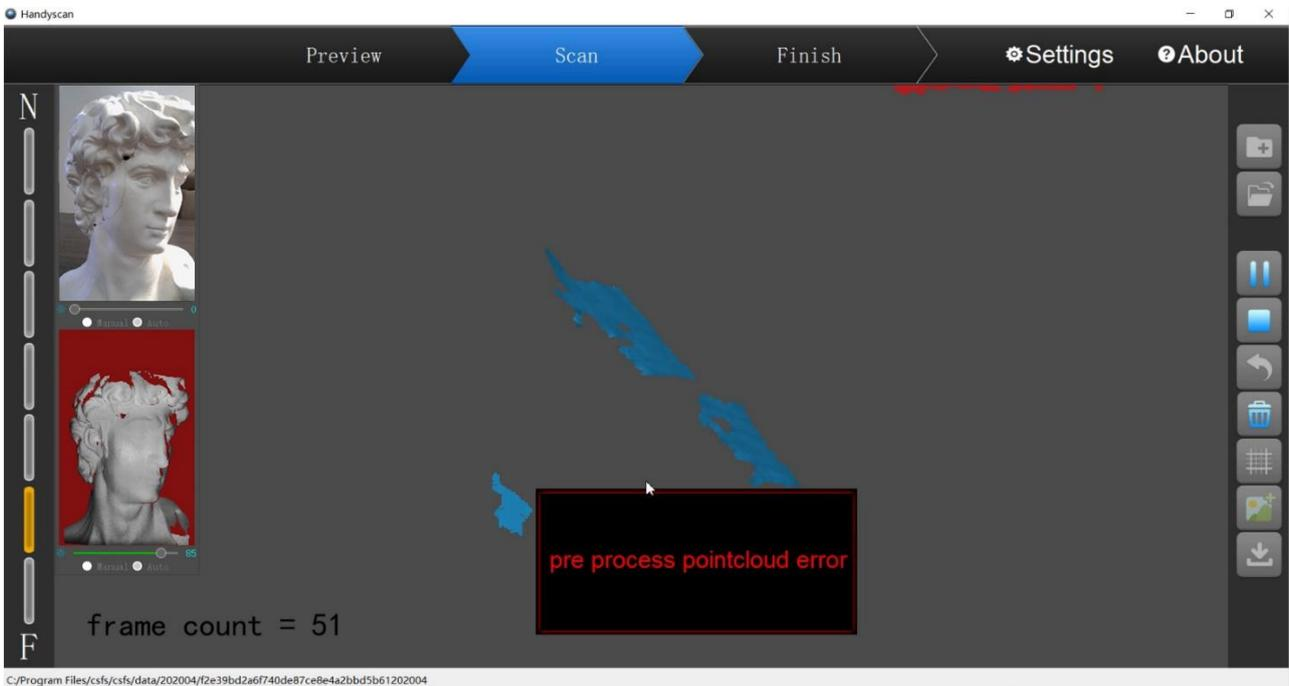
Este mensaje aparece cuando se produce un error de alineación en el caso de escanear planos u objetos con pocas características. Para resolver este problema, puede utilizar un objeto auxiliar o adjuntar puntos de marcador a la superficie del objeto y seleccionar el modo de alineación del marcador antes de escanear.
