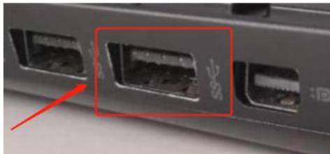
Conecte el cable de datos USB al puerto USB 3.0 del ordenador (el puerto USB3.0 tiene una marca SS al lado).
